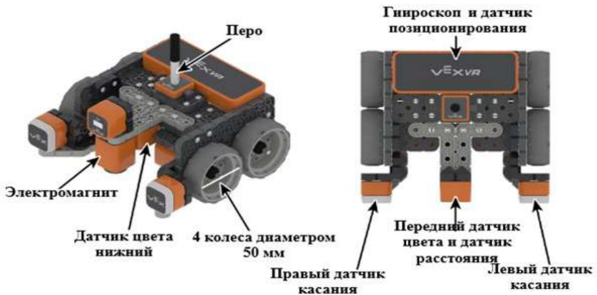
Рис. 7. Конфигурация датчиков робота
